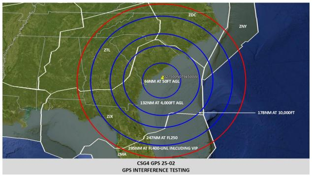
**CSG4 GPS 25-02 GPS INTERFERENCE TESTING**
