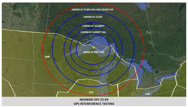
**MOHKMI GPS 25-69 GPS INTERFERENCE TESTING**
