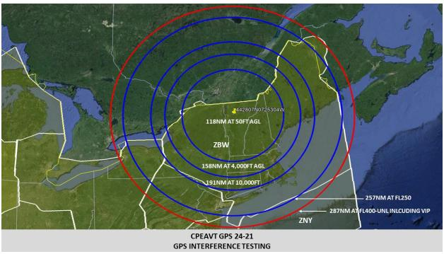
**CPEAVT GPS 24-21 GPS INTERFERENCE TESTING**
