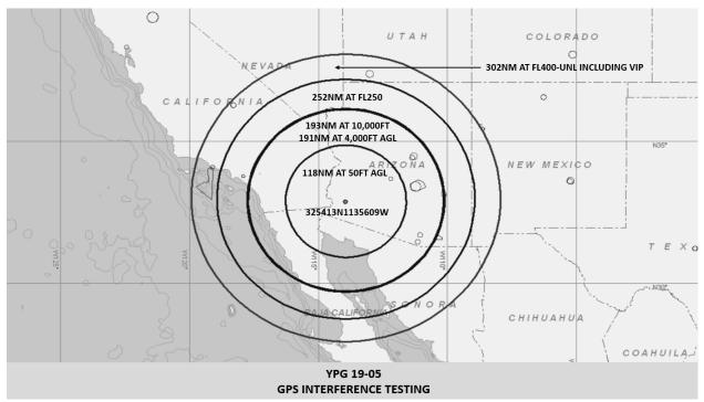
**YPG 19-05 GPS INTERFERENCE TESTING**
