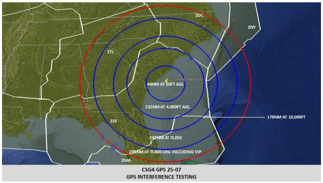
**CSG4 GPS 25-07 GPS INTERFERENCE TESTING**
