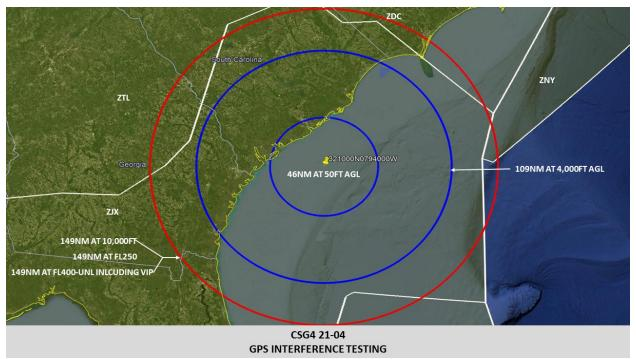
**CSG4 21-04 GPS INTERFERENCE TESTING**
