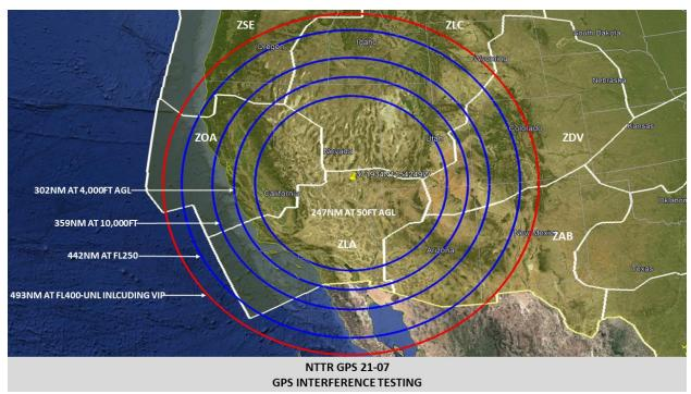
NTTR GPS 21-07 GPS INTERFERENCE TESTING
